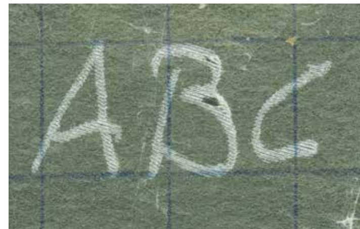
Gestetner-Schablonenpapier. Neo-Cylostyle-Pen mit Perforationsrad.
