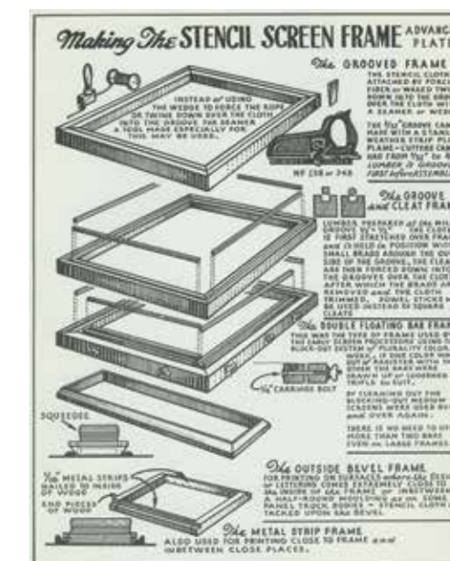
Hietts Anleitung zur Herstellung von Siebdruckrahmen, 1945. Signs of the Times, April und Mai 1945
